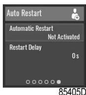
В контроллере имеется встроенная функция автоматического перезапуска компрессора, когда напряжение питания восстанавливается после отказа электроснабжения. Эта функция отключается в компрессорах, покидающих завод, и может быть изменена только после ввода пароля. Обратитесь к своему поставщику, чтобы активировать эту функцию.
