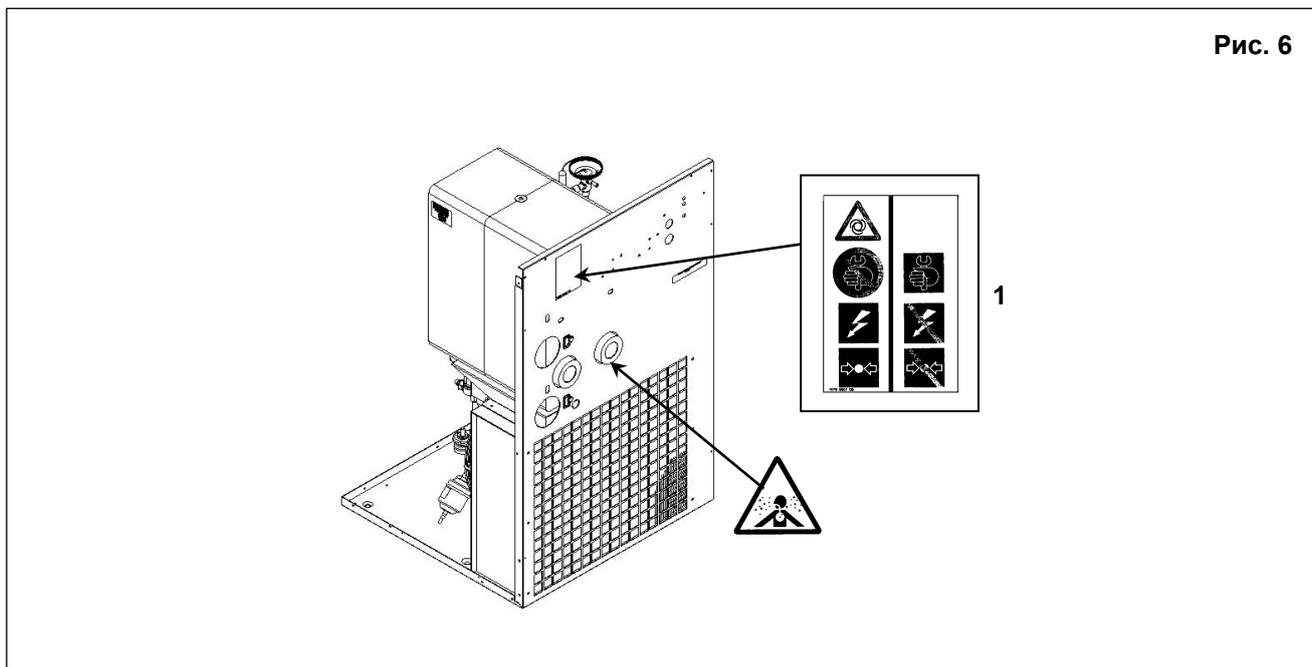
8.3 РАСПОЛОЖЕНИЕ ТАБЛИЧЕК С ДАННЫМИ НА КОМПРЕССОРНОМ БЛОКЕ
