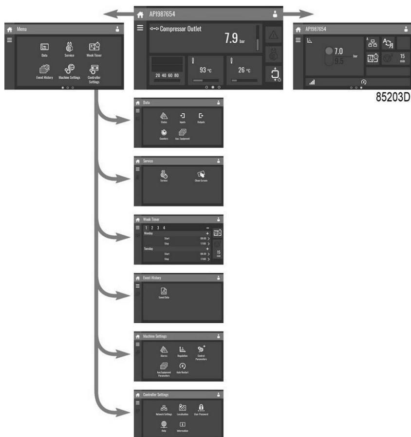
Это структура основного меню. Структура может быть различной в зависимости от конфигурации устройства.
