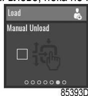
Разгрузка вручную может быть активирована только тогда, когда машина находится в режиме НАГРУЗКА и Локальное управление.
