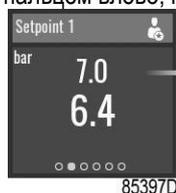
Чтобы выбрать установленное значение загрузки и выгрузки или изменить значения, см. раздел Выбрать или изменить настройку.
