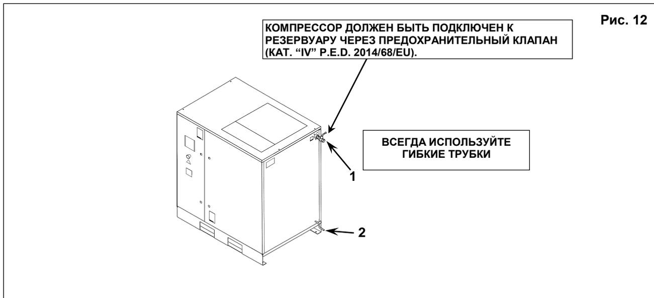
Автоматический слив конденсата (поз. 2, рис. 12) проведен снаружи машины гибкими трубками, которые можно проверить. Слив должен соответствовать требованиям местных действующих нормативных актов.
