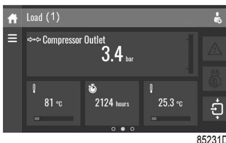
На информационной панели экрана (1) вместо серийного номера установки будет отображаться текущее состояние устройства.
