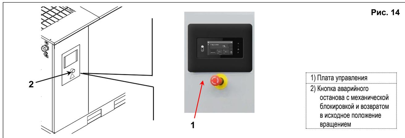
**14.3 КОНТРОЛЛЕР SWIPE (контроллер по умолчанию для устройств с фиксированной скоростью)**
