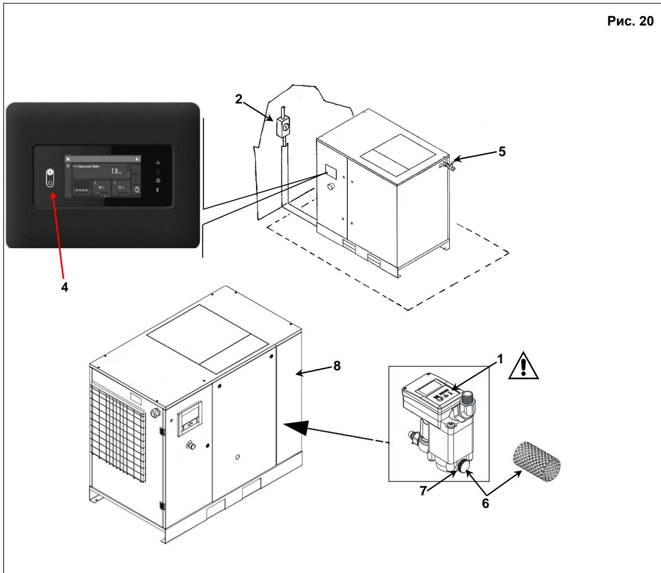
**15.8 ОЧИСТИТЕ СЕТКУ ДРЕНАЖА (ТОЛЬКО ДЛЯ УСТАНОВОК, ОСНАЩЕННЫХ С ХОЛОДИЛЬНЫМ ОСУШИТЕЛЕМ)**
