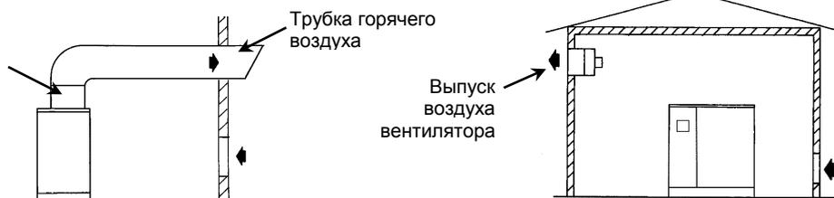
Обеспечьте надлежащий состав воздуха в машинном зале: - чистый, без вредных примесей (например, пыли, волокон, мелкого песка) - без взрывоопасных или химических неустойчивых газов или паров - без кислотообразующих или щелочных веществ, особенно аммиака, хлора или сероводорода.
